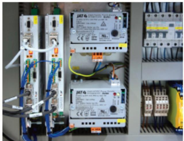
► Die Servoverstärker im Schaltschrank steuern die präzise Bewegung der Bauplattform.
